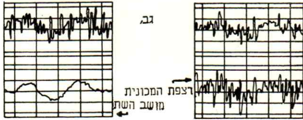
ציור מס' 8 העקומות שנתקבלו בניסוי מכונית בעלת משענת קבועה
