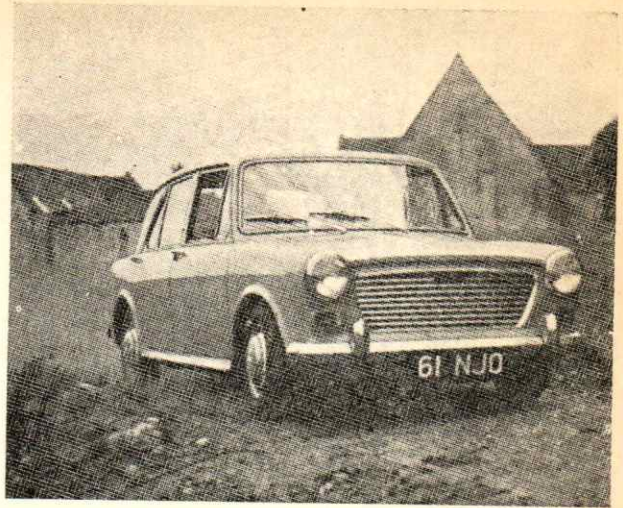
בזכות התקנת המערכת ההידרואלסטית, חופשית למעשה הנסיעה במוריס 1100 מנדנד, וקשיחות הטלטול שלה גבוהה. בתמונה נראית המכונת כשהיא נוסעת במהירות בסיבוב על פני שטח-קרקע קשה
