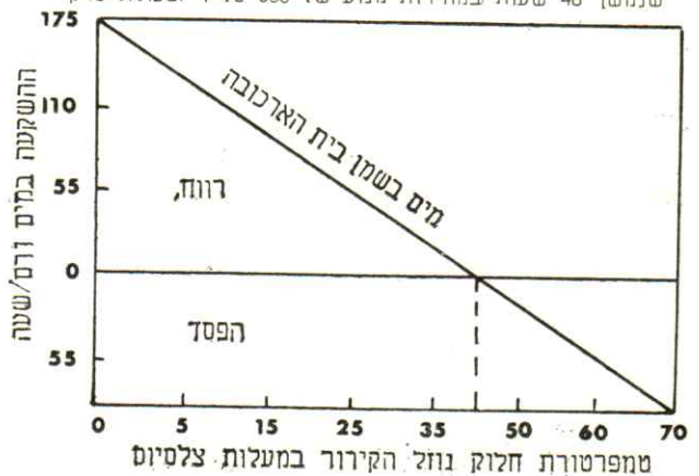
ציור מס' 3 — מידת שקיעת המים על קירות הצילינדר במנוע בינוני — בטמפרטורות שונות. טמפרטורות מביאות לשקיעה גדולה יותר ובטופו של דבר גורמות לחלודה
