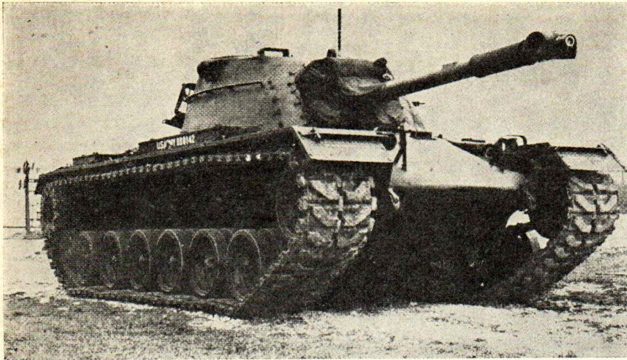
טנק בינוני מצויד במערכת מחוץ, האנטנה והמשואה מורכבות על גבי הצריח
